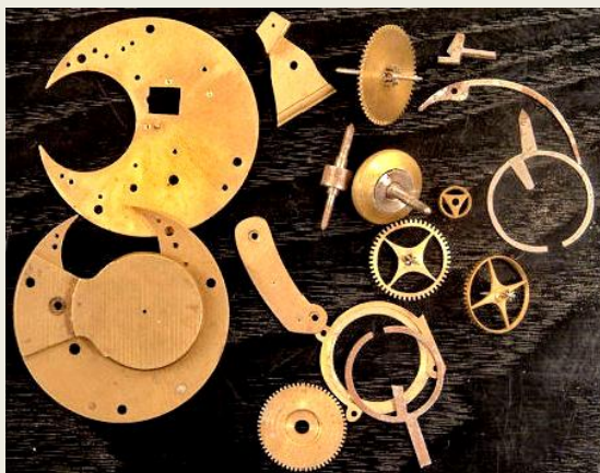
Movimento grezzo per orologio a verga. In basso un altro movimento dell'ultimo quarto dell'800, nella scatola di corteccia di betulla.
