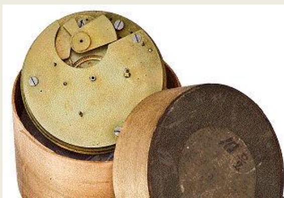
Movimento grezzo per orologio a verga. In basso un altro movimento dell'ultimo quarto dell'800, nella scatola di corteccia di betulla.
