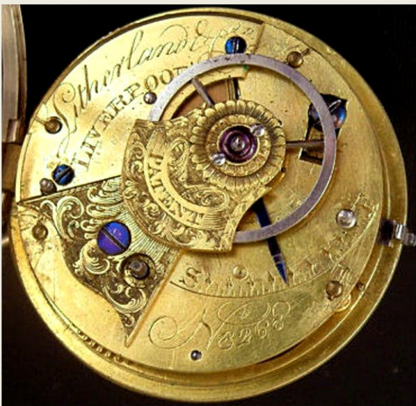
Movimento di P. Litherland , Liverpool, n.3268 del 1803. Porta la scritta Patent .
