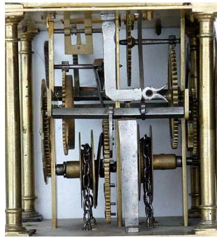
Foto a sinistra: struttura della 'gabbia' con, nella parte posteriore, semi-anello per sospendere l'orologio a muro ed, in basso, i distanziatori per mantenerlo perpendicolare.
