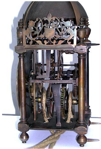
Foto a sinistra: struttura della 'gabbia' con, nella parte posteriore, semi-anello per sospendere l'orologio a muro ed, in basso, i distanziatori per mantenerlo perpendicolare.
