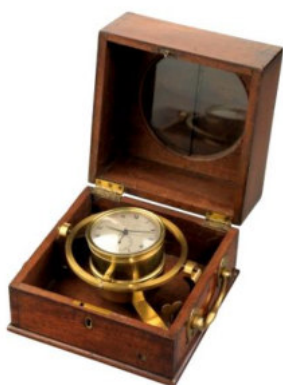
Il cronometro n° 509 di Thomas Earnshaw. Si tratta di un cronometro con carica di 1 giorno, di piccole dimensioni ed inserito in un anello di ottone oscillante all'interno di una
