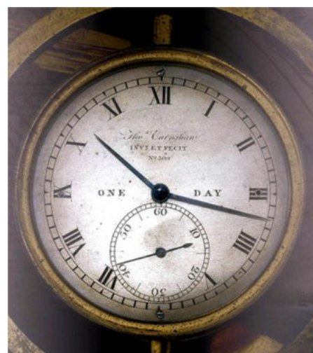
Il cronometro n° 509 di Thomas Earnshaw. Si tratta di un cronometro con carica di 1 giorno, di piccole dimensioni ed inserito in un anello di ottone oscillante all'interno di una
