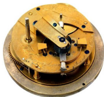
Il cronometro n° 509 di Thomas Earnshaw. Si tratta di un cronometro con carica di 1 giorno, di piccole dimensioni ed inserito in un anello di ottone oscillante all'interno di una
