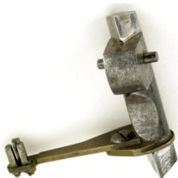
La foto a sinistra, mostra invece il sistema, visto dal basso, con tre palette su di un corto braccio che, posto lateralmente al pendolo, è in grado di dare/ricevere l'impulso.
