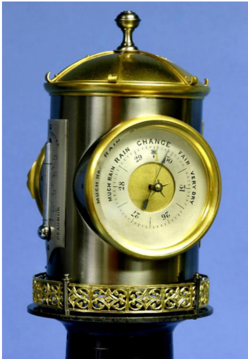
Figura 15 1885 ca. In bronzo ed ottone, quadrante orario, barometro e termometro, la parte superiore (lanterna) ruota per 6 ore ad ogni carica che viene effettuata attraverso una porta sulla base. Altezza 43,18 cm.
