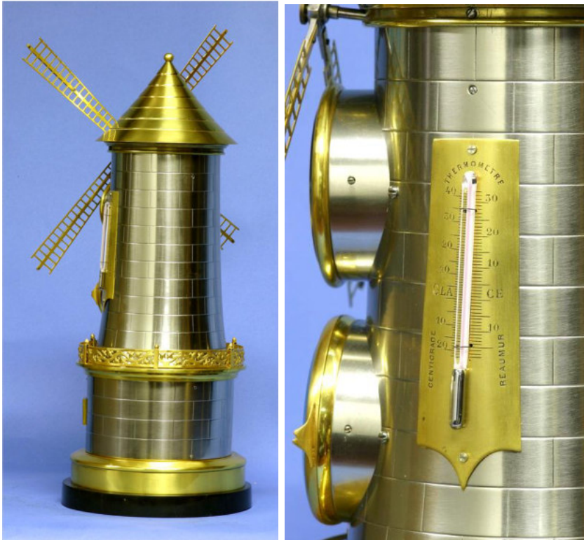
Figura 8 1890 ca. Orologio carica 8gg, barometro e termometro a forma di mulino. Un motore a molla sulla base consente una automazione delle pale per 6 ore.
