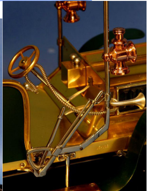
Figura 11 1910 ca. Orologio molto curato nei dettagli, costruito in acciaio, bronzo ed ottone, tendine in seta ai finestrini, raggi delle ruote e fanali in acciaio argentato, appoggia su una base in marmo venato. Sulla fiancata destra ha orologio e barometro, il termometro è sul lato sinistro. Anche qui la manovella d'avviamento aziona un meccanismo a molla che fa girare le ruote per 8 ore, Fabbricazione francese per committente estero. Altezza 30,48 larghezza 43,18 cm.
