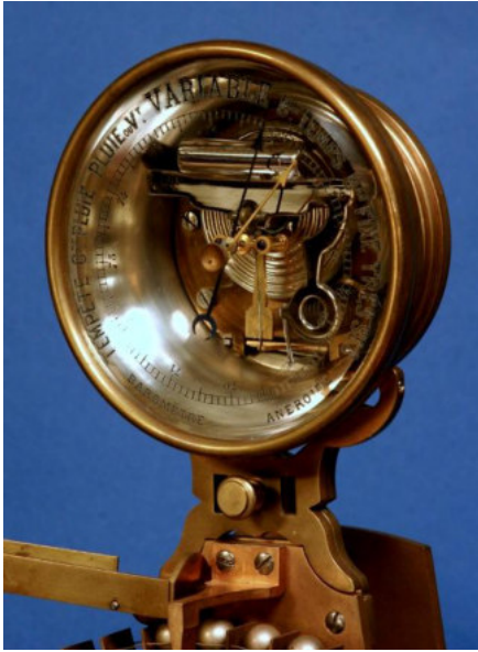
Figura 14 1900 ca. Quadrante in vetro per l'orologio, barometro e termometro ad alcol. Il peso delle sfere aziona, per gravità, la grande ruota dietro il quadrante; le sfere scendono sul piano inclinato e vengono raccolte dal nastro che poi le riporta sulla ruota. Lo scappamento (tipo Brocot) è azionato dal pendolo. La forza fornita dal peso delle sfere (costante) garantisce precisione a differenza della molla che, con il tempo, perde di elasticità.
