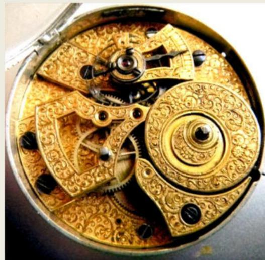
1865 fonderà la Zenith), e provoca, nella lancetta dei secondi, un movimento a scatto che si muove ogni secondo. La ruota di scappamento ha solamente sei denti di blocco e sei denti d'impulso, ma il dente di blocco è doppio ed ognuno termina con una forchetta. Quando la prima punta della forchetta oltrepassa il cilindro, la ruota è
