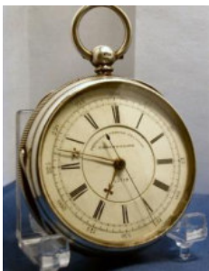
Figura 14 Uno stop watch. L'arresto del bilanciere è azionato dalla levetta che si vede a sinistra della foto.
