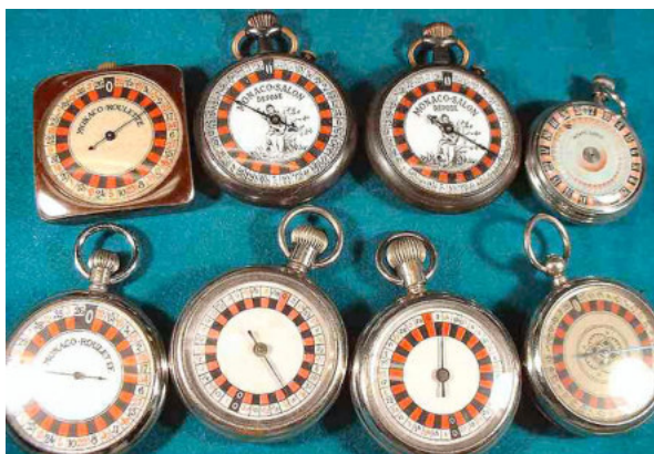
Figura 32 Infine diversi tipi di orologi roulette, oltre a mostrare il tempo, l'azionamento del pendente sgancia una molla che fa ruotare o un indice o l'intero quadrante ed il numero compare su di una finestra.
