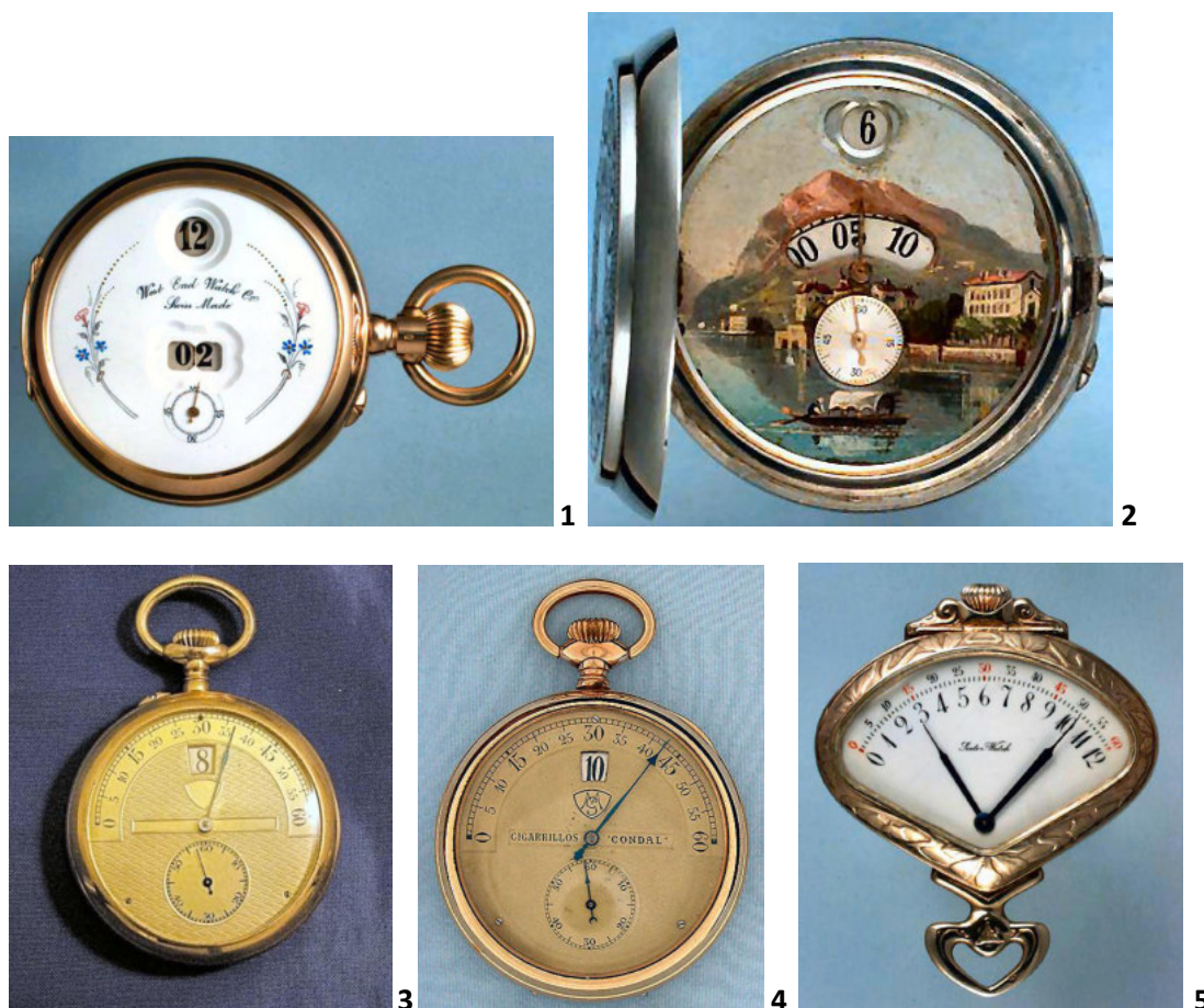
Figura 17 Gli orologi 1 e 2 sono dei salterello a lettura digitale dell'ora e dei minuti mentre rimane analogica quella dei secondi; il 3 ed il 4 sono marchiati Modernista ed uniscono la funzione 'salterello' dell'ora a quella 'fly back' dei minuti; il n°4 reca una scritta pubblicitaria mentre il n°3 è come usciva dalla produzione. Il 5, infine, ha la funzione 'fly back', sia per le ore che per i minuti. Tutti gli orologi sono di produzione svizzera e sono databili tra il 1890 ed i primi anni del 1900.
