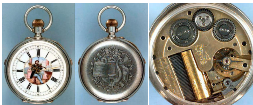
Figura 6 Svizzero 1880 circa, a ripetizione con carillon su tamburo; suona 4 diverse melodie mentre il braccio del violinista sul quadrante ne simula, muovendosi, l'esecuzione.
