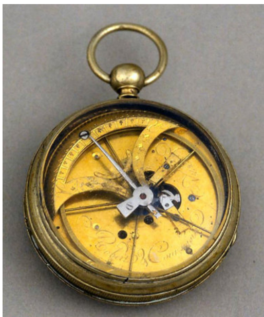
Figura 18 Un orologio particolare, dotato di un grande bilanciere che aziona lo scappamento ad ancora modificato da Jean Moise Pouzait (1743 – 1793). Pouzait è ricordato per l'invenzione dei secondi indipendenti che originò la moderna cronografia.
