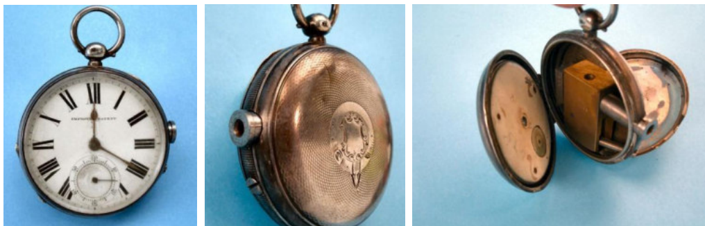
Figura 30 Cassa e quadrante di un orologio inglese della seconda metà dell'800, nessun movimento ma il meccanismo per sparare proiettili da 3 mm.
