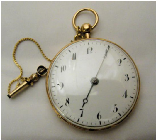
Figura 4 Orologio del 1810 circa a ripetizione ore e quarti azionata premendo il pulsante, notare la speciale chiavetta che, consentendo di caricare l'orologio in una sola direzione, evitava danni al movimento.
