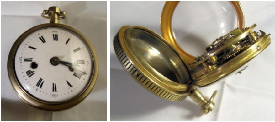
Figura 2 Orologio austriaco (1820 circa) suona le ore al passaggio (clockwatch) e solo le ore a richiesta, tramite un pulsante sul pendente. E' visibile la campana all'interno della cassa.
