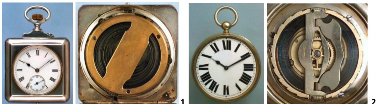
Figura 25 Il primo è un orologio di forma quadrata del 1890 circa Svizzera ed aprendo il fondello posteriore è visibile la grande molla di carica che copre il movimento; il n°2 è invece (sempre della stessa origine e periodo) un orologio insolitamente largo (73 mm) ed in cui la carica non viene effettuata dal remontoir, ma da una grossa chiavetta, fissa e ribaltabile, posta sulla molla.
