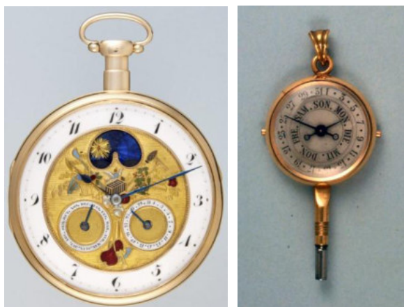
Figura 12 Svizzera 1820 circa, calendario con equazione del tempo; la finestrella in alto mostra la durata del giorno in funzione del mese: massima a Giugno minima a Dicembre quando il sole viene mostrato per poche ore. La seconda foto mostra una chiave calendario in oro e acciaio, 1720 circa, dove le indicazioni di data vengono azionate da due pulsantini laterali.
