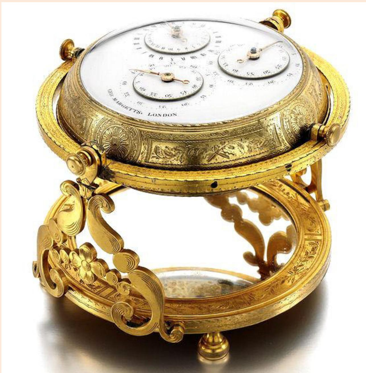
*Orologio con scappamento cronometro (tipo Arnold); il movimento ha il n° 316 ed è largo 115 mm. Montato su un supporto (probabilmente successivo) con giunti cardanici ed uno specchio nella parte inferiore per poter osservare il movimento. Segna sia il tempo solare che quello siderale. (Dal catalogo online di Sotheby's asta del 15 Dicembre 2015).*
