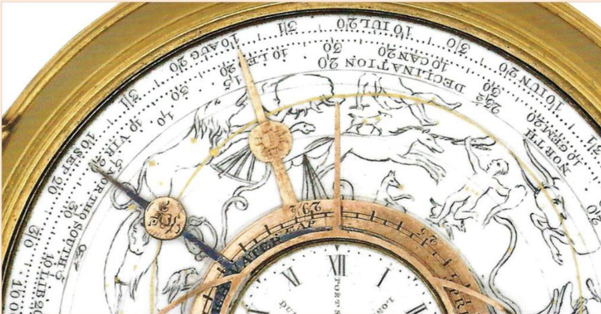
Un esempio di lettura di una parte del quadrante (da una foto tratta da "Watches" di D.Thompson). La lancetta delle ore segna le 5 del mattino del 9 Agosto (anno imprecisato), il Sole lascia la costellazione del Cancro per entrare in quella del Leone, la Luna è invece in quella della Vergine con un'inclinazione di 20°; nel porto di Dublino la marea raggiunge il livello massimo (high water), ecc. Insomma non sarà stato un orologio di scientifica precisione, ma è comunque affascinante.
