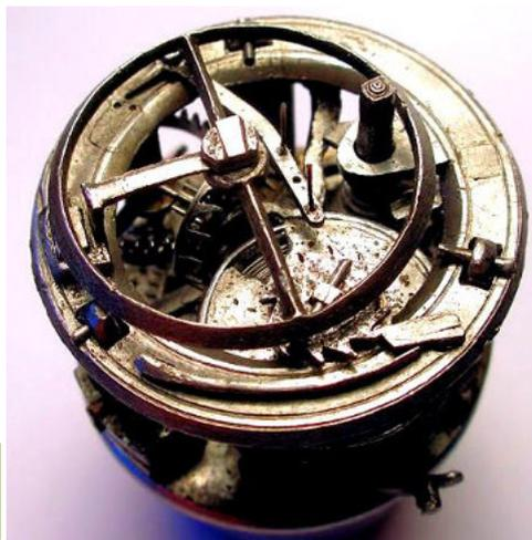
Il bilanciore veniva costruito usando una sbarra di ferro, piegata ad anello e saldata martellando il metallo arroventato. Con lo stesso sistema<sup>19</sup> si saldavano i bracci ed il quadro del bilanciore che veniva poi forato per il passaggio dell'asse. In maniera analoga venivano costruite le ruote, la cui dentatura veniva effettuata manualmente. Dal già citato libro di Antonio Simoni ( vedi nota 18) si ha un elenco del tipo di bilanciore usati nell'orologeria primordiale.
