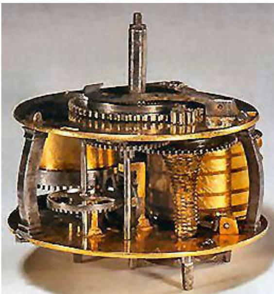
Nel movimento si notano i pilastri curvi per assecondare la forma della cassa, i due bariletti in ottone (carica e suoneria) e l'alto conoide con almeno 15 gole. La curvatura dei pilastri, anziché la smussatura, è testimonianza che quel movimento è stato progettato per una cassa sferica.
