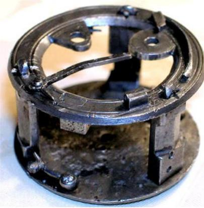
Nei primi orologi la distanza tra le due platine era determinata dall'altezza del **conoide**. Fu, in seguito, possibile realizzare conoidi più bassi e più larghi, quando si poté disporre di macchine e sistemi di taglio che consentivano maggiori precisioni, ma soprattutto con l'introduzione, nel treno di ruote, del quarto asse che consentì un più lento
