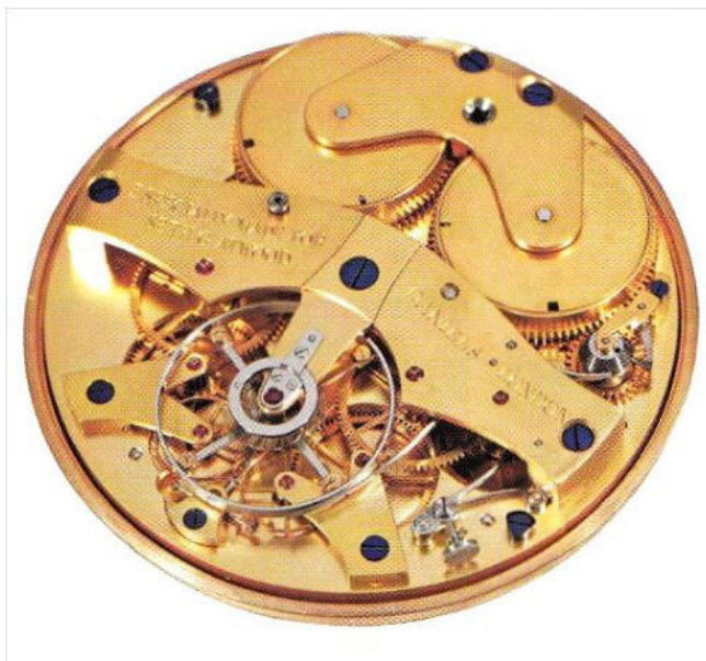
Il movimento con lo scappamento naturale di Daniels con la scritta SPECIALLY MADE FOR SETH ATWOOD — DANIELS LONDON.
