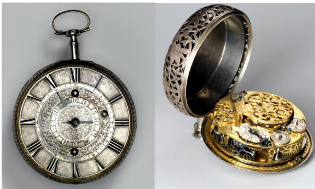
Orologio da carrozza di Thomas Tompion con suoneria al passaggio e sveglia. L'orologio con cassa e quadrante in argento, ha la particolarità di non avere il conoide che Tompion tentò di non usare agli inizi dell'applicazione della spirale del bilanciere, ma poi dovette ricredersi. Possibile datazione 1685.
