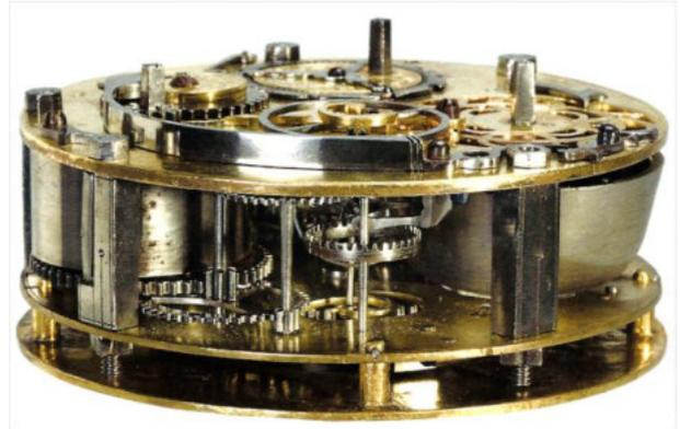
Sulla splendida platina inferiore si notano: lo *stackfreed*, il bilanciere in ferro, l'area della molla di carica della suoneria, traforata per il passaggio del suono.
