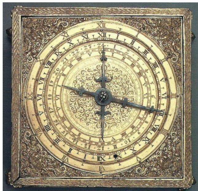
orologi a molla tedeschi del XVI secolo. Un'apertura sul quadrante, in corrispondenza dell'ora desiderata per la sveglia, consente il collegamento tramite leva del meccanismo di suoneria; la sfera delle ore al raggiungimento dell'ora settata fa scattare la suoneria. Questa è costituita da una molla con un treno di ruote che pilota una ruota corona ed uno scappamento a verga che agisce su di un martelletto che, allo
