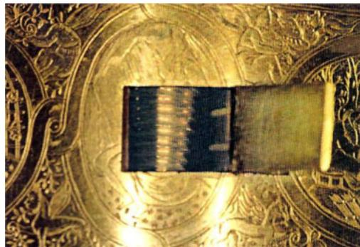
Sportello per il controllo di eventuali rotture della corda di budello del **conoide**; forma delle gole del conoide per la corda di budello.
