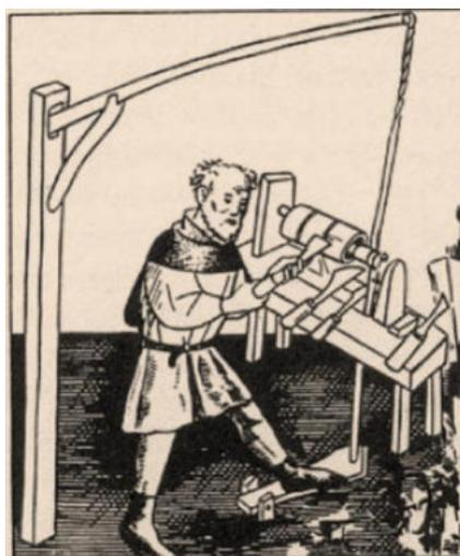
Due torni a pedale in uso in Germania: il primo del 1395 ed il secondo del 1568 in cui il tornitore ha bisogno di un assistente per azionare il pedale.<sup>25</sup>
