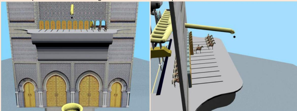
*L'ingegnoso meccanismo. Due diverse prospettive della fase, ripetuta ogni ora, di caduta della pallina e dell'uscita del cavaliere. In basso: lo sganciamento del peso per l'uscita del cavaliere e la situazione di partenza.*
