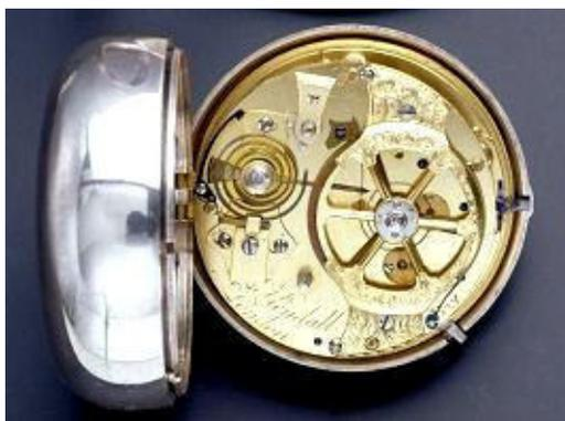
Clutton corregge il Catalogo, che attribuiva all'orologio uno scappamento *spring-detent*, e correttamente lo definisce *pivot detent*, con molla di ritorno elicoidale. Ci dice che la ruota di scappamento ha i denti con la stessa forma di uno scappamento ad ancora e che la platina superiore dell'orologio si presenta come una versione più piccola dei noti orologi da marina di Kendall.
