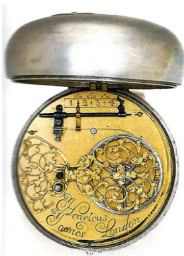
L'orologio ha doppia cassa in argento, quella esterna è rivestita in zigrino con *pinwork* in argento. Il movimento è a doppia platina, scappamento a verga, treno di 5 ruote, conoide con catena, corta molla spirale e regolatore di Barrow.
