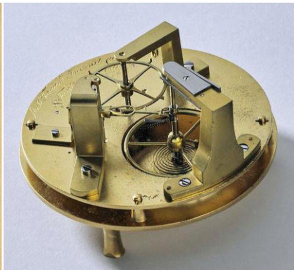
*Schema dello scappamento **brisé et à surprise** e suo modello
