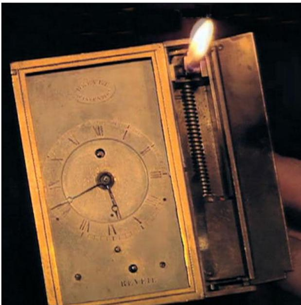
Le prime due foto riguardano un orologio, con carica posteriore, che corrisponde al suo primo brevetto. La sveglia viene settata pressando un bottone in alto sull'esterno della cassa.
