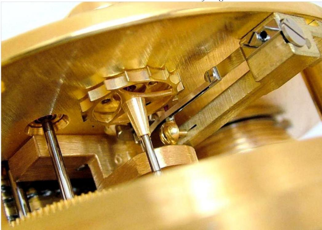
*Detent con viti di regolazione e bloccaggio*
