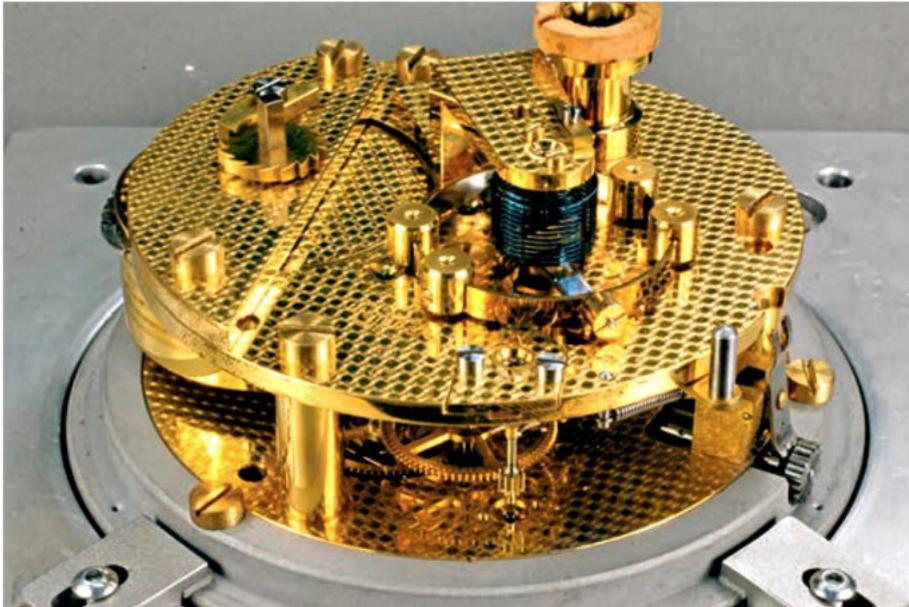
La proposta è stata avanzata perché la produzione di cronometri ad ancora significherebbe un risparmio di manodopera del 20% rispetto ai cronometri a *detent*. Questo risparmio si ottiene eliminando alcuni o e facilitando la regolazione. Tuttavia, l'OKM ha imposto la restrizione che i cronometri ad ancora dovrebbero essere utilizzati solo su navi esposte a forti vibrazioni. Inoltre, l'OKM concorda sul fatto che i cronometri ad ancora siano forniti alle navi mercantili,
