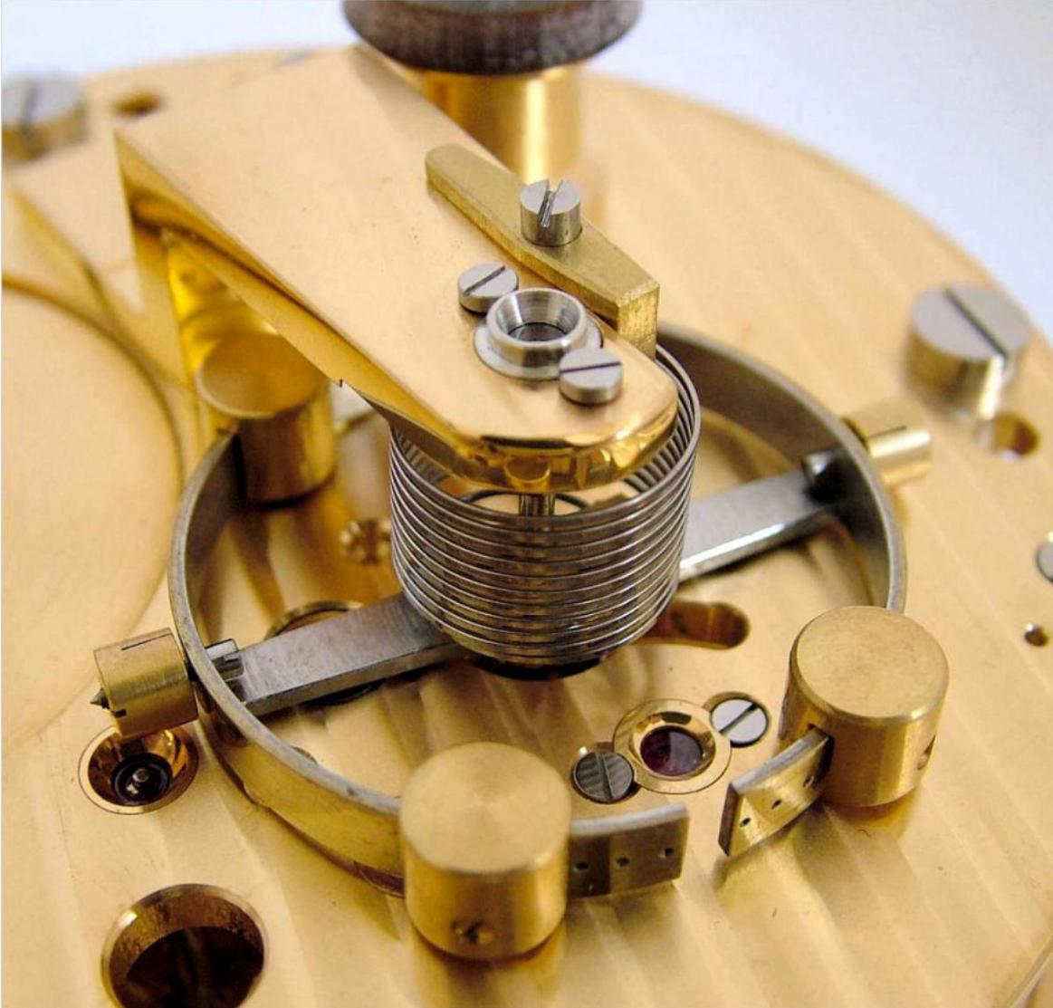
*Foto del bilanciere e spirale di un M6X*
