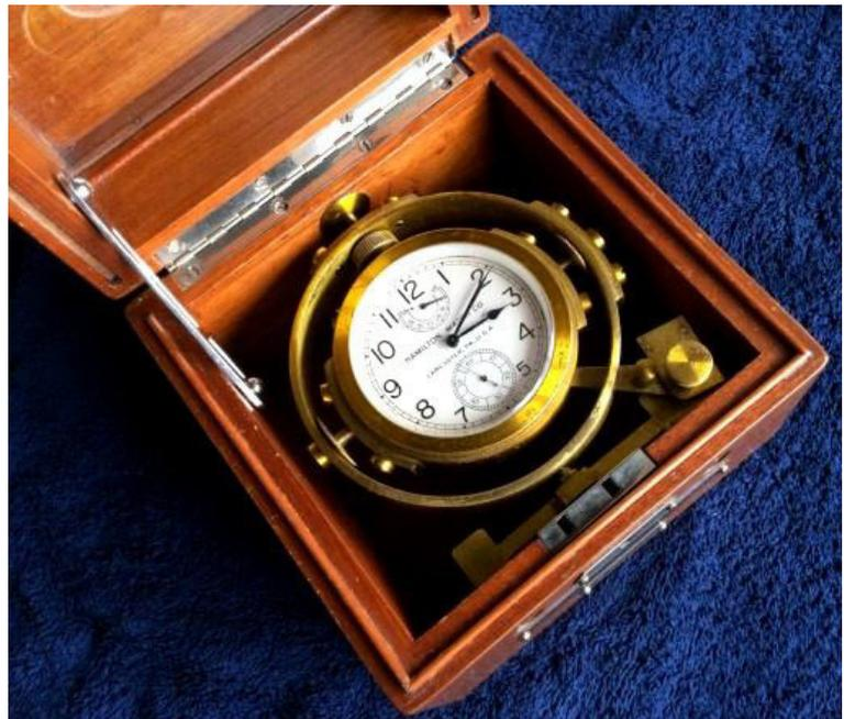
*Orologio M22 senza e con giunto cardanico, nella custodia e con seconda custodia per il trasporto*
