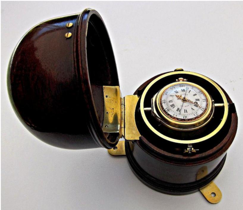
*Le Roy n. 4732 sembra essere il terzo orologio di questo tipo, noto per essere stato prodotto. È quasi identico a quello del Museo Beyer, ma il dispositivo di compensazione della temperatura sulla piastra posteriore, è regolabile.*
