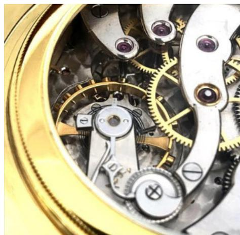
Questo calibro della Longines, scappamento ad ancora con bilanciere Guillaume, di cui sono stati realizzati solo 12 esemplari, è stato appositamente progettato per i test di Osservatorio.
